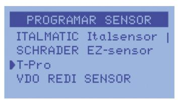
Programe rápidamente los sensores, una rueda a la vez. Para reprogramar, utilice TPMS Go con una herramienta de exploración de diagnóstico o siga las instrucciones del vehículo para volver a programar de forma automática o manual
